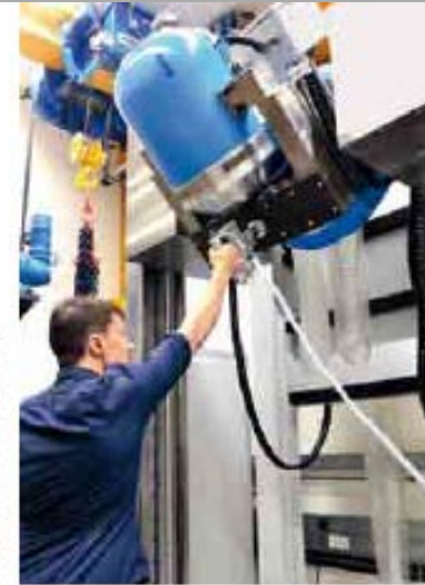
Am Shaker werden die dynamischen Eigenschaften des menschlichen Arms vermessen The shaker is used to measure dynamic properties of the human arm
